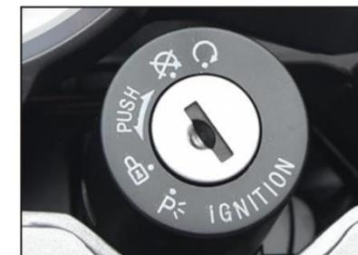
El interruptor de encendido tiene cuatro posiciones:
