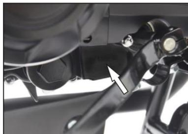
Placa de metal: La placa de metal se fija en el tubo vertical derecho del marco.
