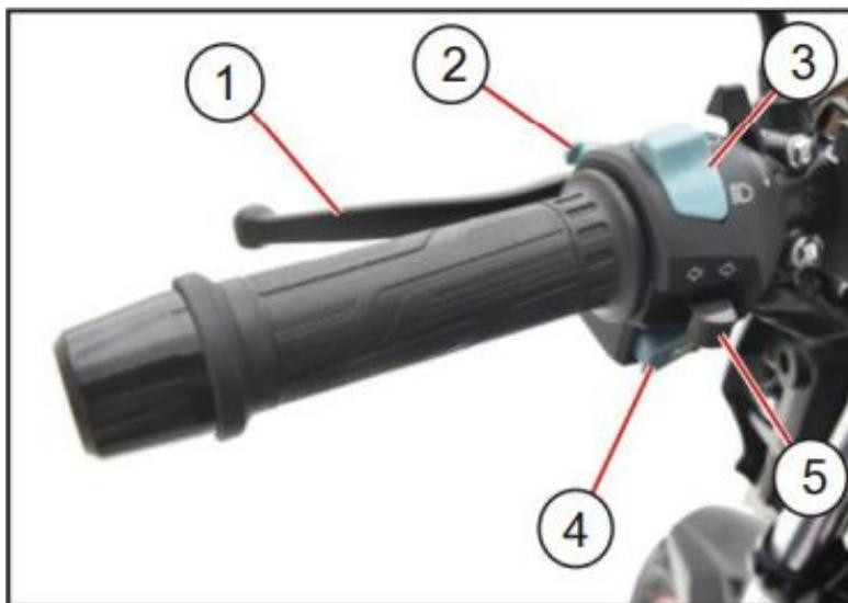
1. Mango de embrague: Al arrancar el motor, frenar o cambiar, sostenga firmemente la manija para separar la placa de fricción del embrague y cortar el sistema de transmisión.
