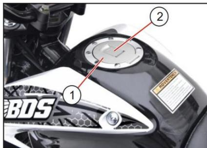
Para abrir la tapa del tanque de combustible, primero abra la placa de cubierta pequeña, inserte la llave en el orificio de la cerradura y levante la tapa del tanque de combustible mientras gira la llave en el sentido de las agujas del reloj.
